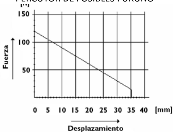
DIAGRAMA DE FUERZA-D ESPLAZAMIENTO DEL PERNO PERCUTOR DE FUSIBLES FURUNO®
